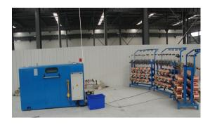
2. Foaming Core wire extruding 芯线发泡挤出机
